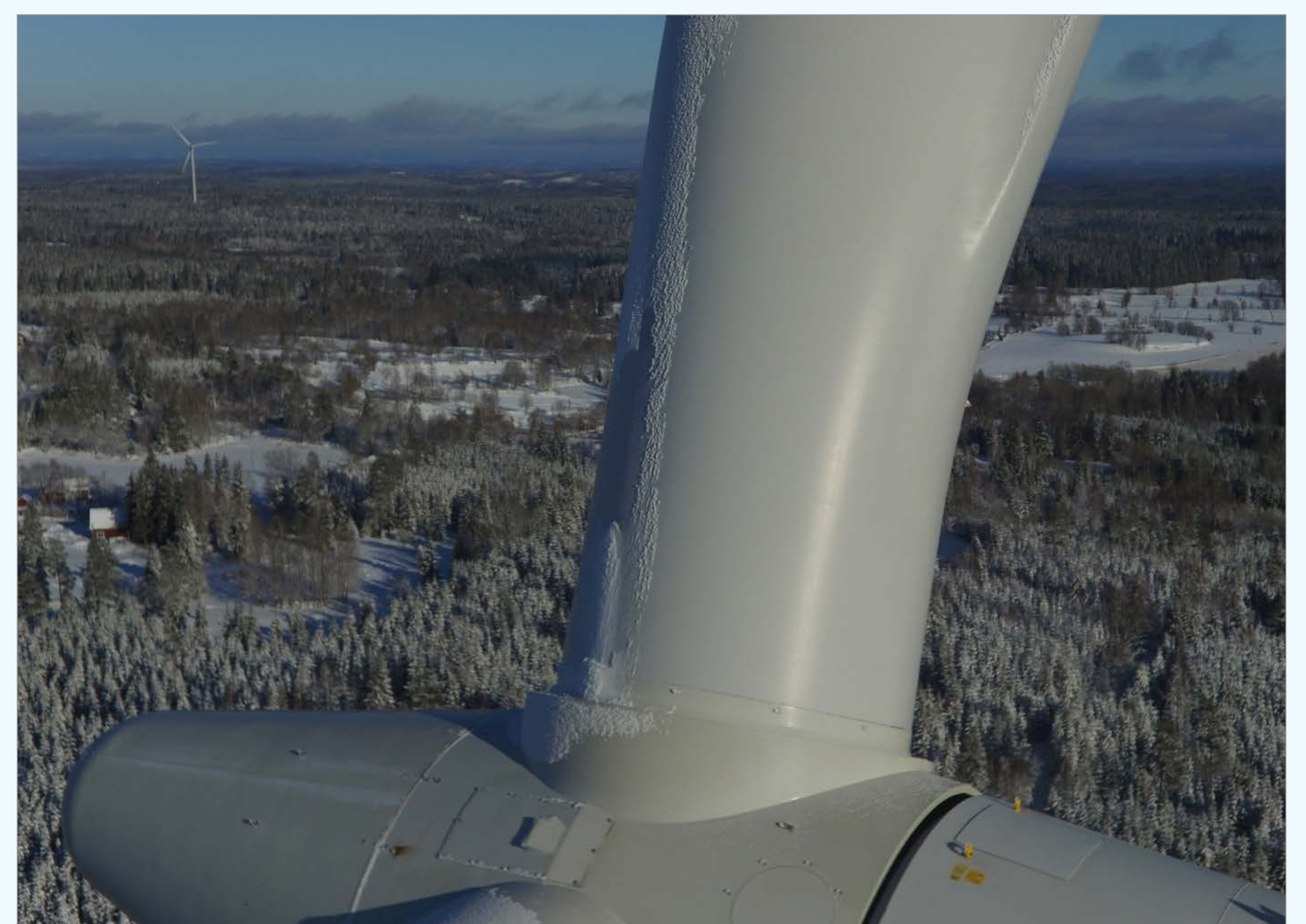
Isbildning på vindkraftverk
