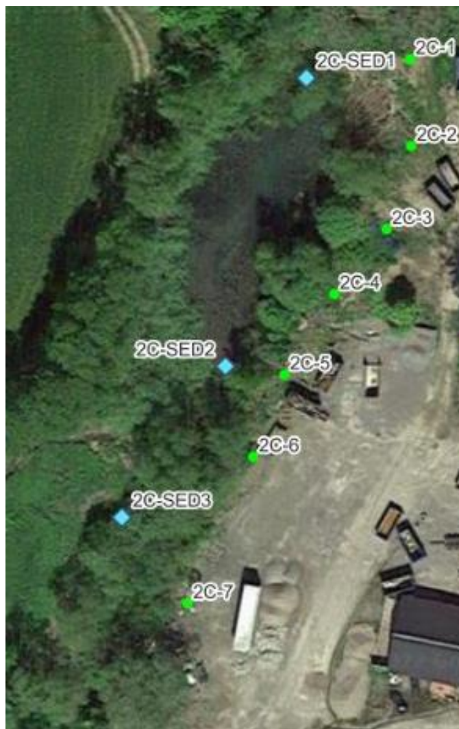
Figur 19. I anslutning till dammen har jordprover uttagits i sju punkter utefter slänten (gröna punkter i figuren, 2C-1 till 2C-7) och tre sedimentprover i dammen (blå romber, 2C-SED1 till 2C-SED3). Utsnitt ur figur från (Structor Miljö Öst, 2023).
