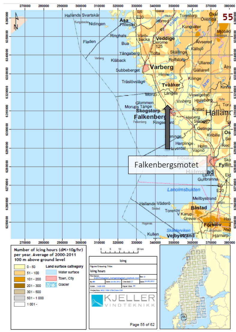
Figur 18. Kjeller Vindtekniks nedslagningskarta visar antalet beräknade timmar med ispåbyggnad per år.
